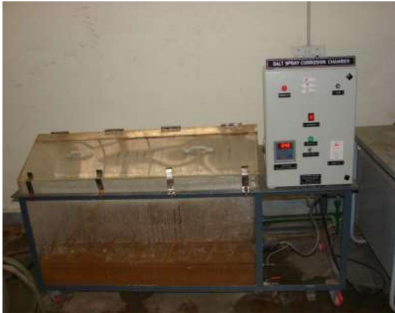
**Fig. 1.5: Salt spray fog type corrosion test apparatus**
